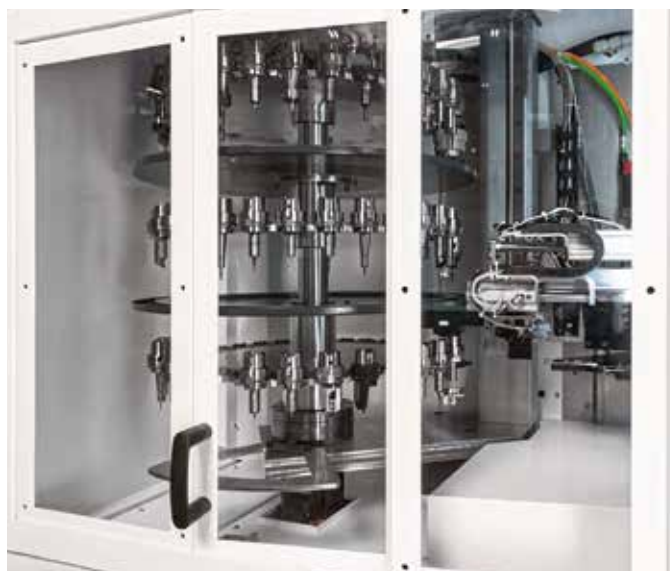
Le magasin d'outils dispose de 90 positions et intègre maintenant un palpeur de bris d'outils en temps masqué.
