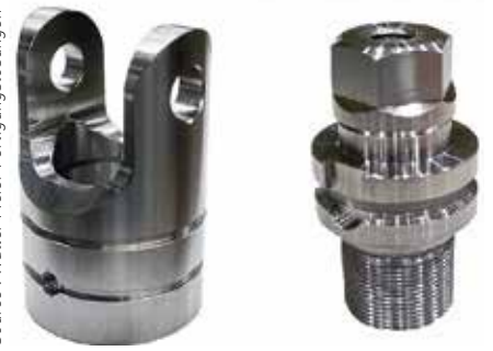
Composants typiques pouvant être fabriqués sur le Nakamura Tome SC-100X2.
