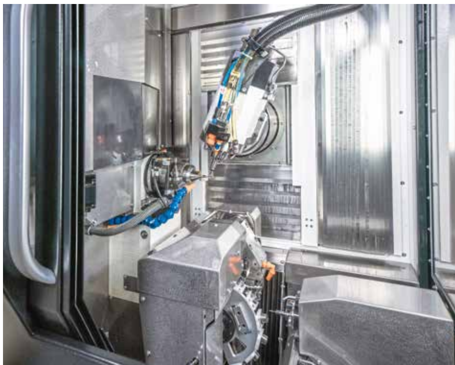
C'est une fois à l'intérieur que la différence saute aux yeux avec l'intégration d'une seconde unité 3 axes avec la 2 e motobroche haute vitesse et son magasin d'outils dédié... à découvrir au SIAMS.
