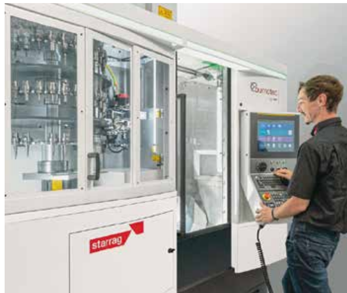
Son interface homme-machine, développé sur une base PC sous Windows, permet d'un simple geste du doigt de passer d'un écran à l'autre.
