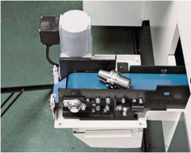
Le Nakamura-Tome SC-100X2 est équipé d'un préhenseur de pièces.
