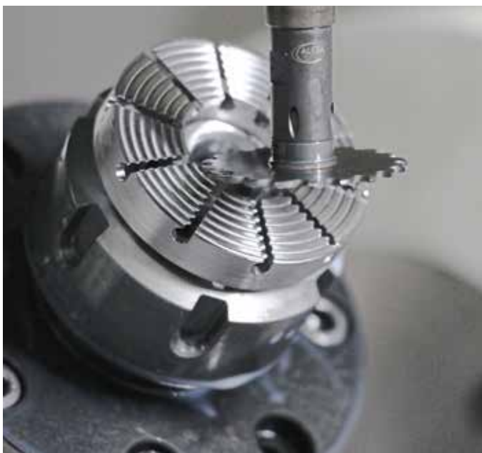
Hier kommt das Nutex Mono zum Einsatz, um die notwendigen Schlitzte in diesem rostfreien Instrument zu fräsen.
