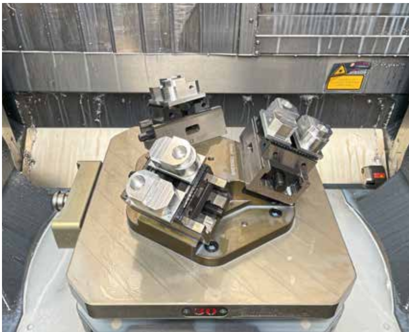
Kompakt: Spannpyramiden ermöglichen eine Mehrfachaufspannung mit ausreichender Zugänglichkeit der Werkstücke zum fünfachsigen Bearbeiten.
