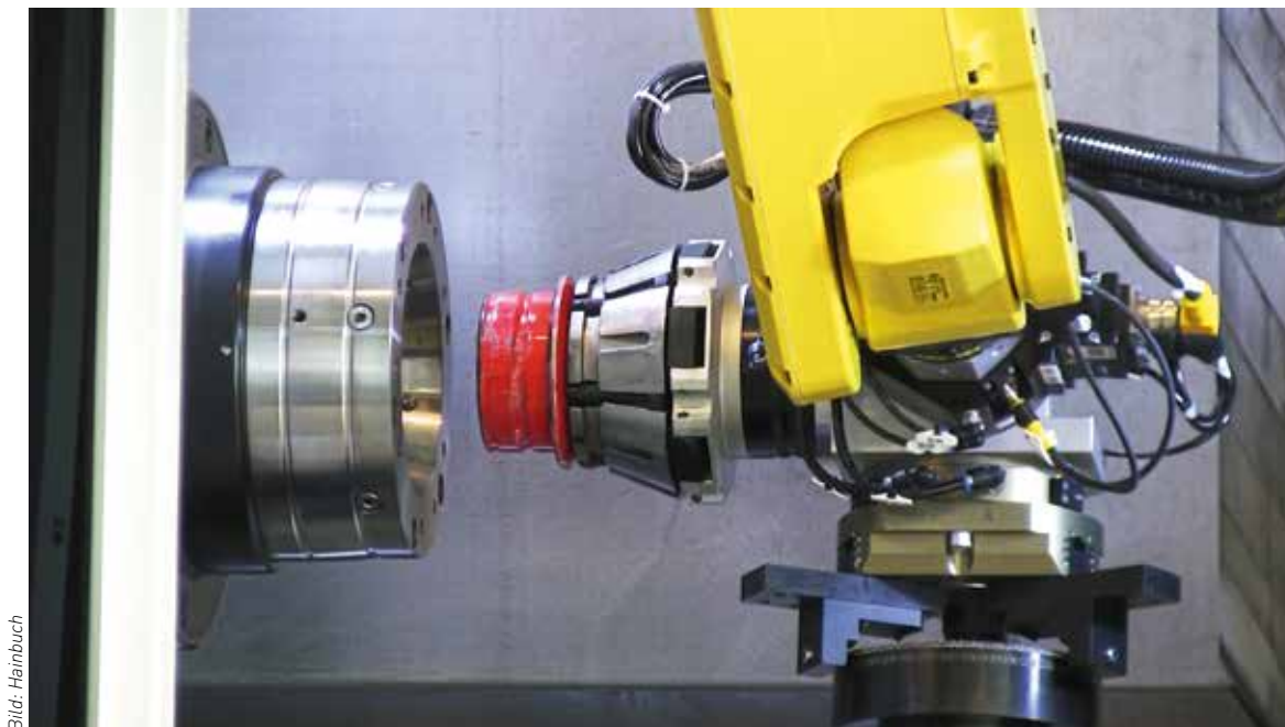
Der automatische Spannkopf- und Werkstückanschlagwechsel mit dem Spannfutter «TOPlus» AC.
