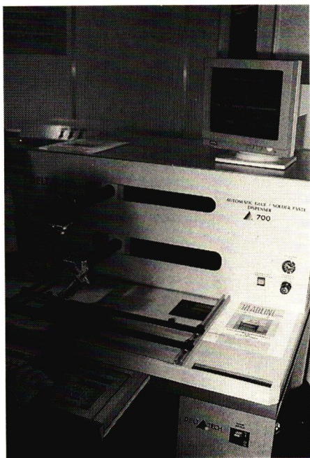
Fig. 4. La nouvelle machine à souder les composants sur les circuits imprimés de la firme Deltatech SA, Tramelan.
