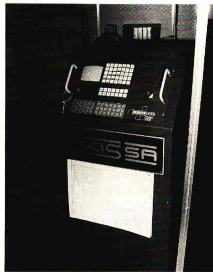
Fig. 5. Commande numérique pour une fraiseuse 4 axes, produite par la société Sixis à La Neuveville.
