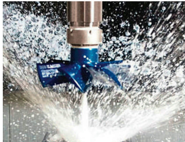
Pfiffige Lösung: Der Chip Fan entfernt schnell Späne und Kühlmittel ohne Unterbrechung der Produktion. (Bild: Big Kaiser)
