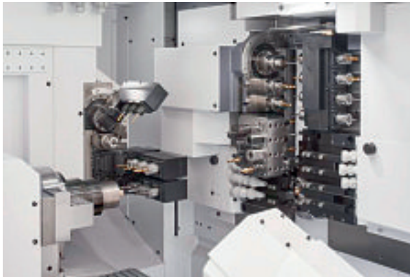
Rekordverdächtig: Die Cincom D25 kann auf 12 Achsen mit bis zu 59 Werkzeugen zerspanen. (Bild: Citizen)
