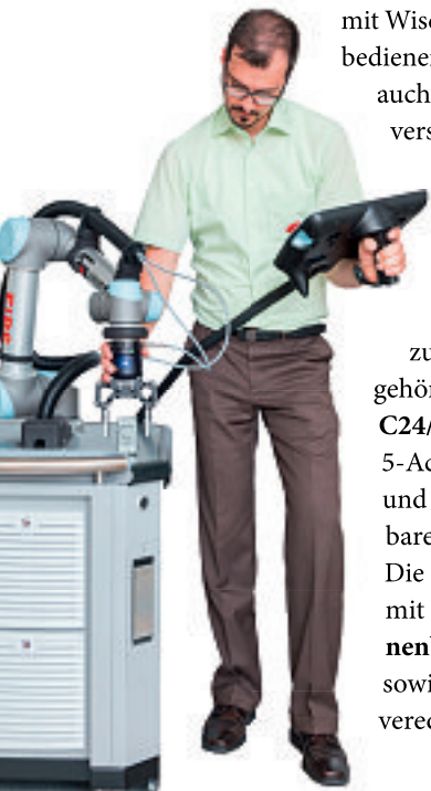
Einfache Automatisierung: Das Be- und Entladesystem RoboCart wird von einem kollaborativen Roboter dominiert. (Bild: Intool)
