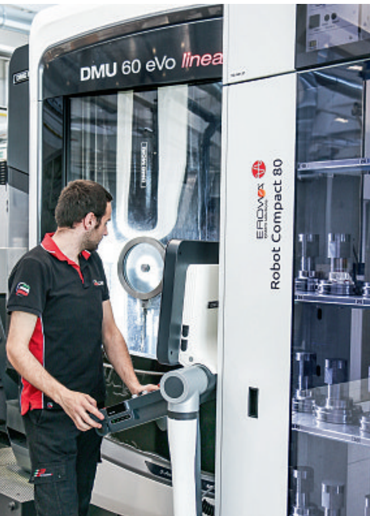
Der Erowa Robot Compact 80 meistert bis zu 80 kg Transfergewicht und bietet grosse Magazinkapazität für eine gemischte Magazinbelegung. (Bilder: Erowa)
