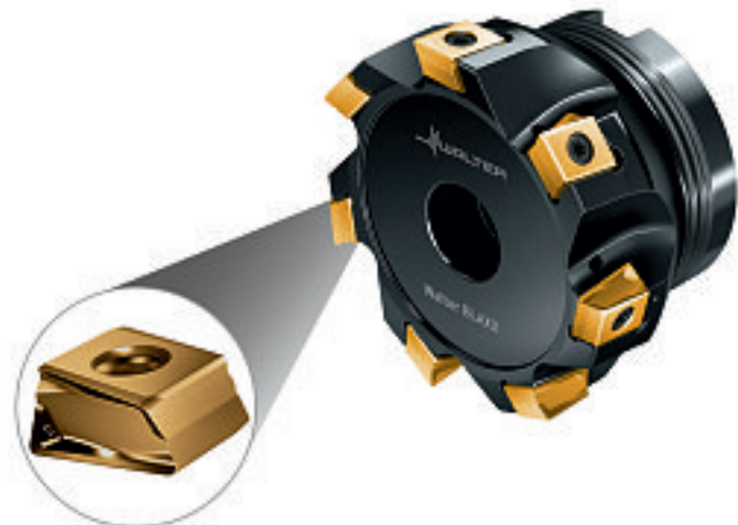
Die umfangsgesinterten Schneidplatten besitzen jeweils vier Schneiden und zeigen beim Einsatz in den Blaxx-Fräsern eine hohe Rund- und Planlaufgenauigkeit. (Bild: Walter)
