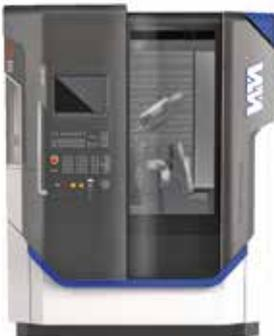
**SIAMS / B2C3 / 1.1** – Le centre d'usinage multi-process 6 à 8 axes 508MT2 Linear bénéficie des derniers développements de Willemin-Macodel. Equipé d'un passage de barre de diamètre 42 mm de base, ce centre de fraisage-tournage est composé d'une tourelle de reprise à 3 positions utiles (contre-broche axe C, étau et contre-pointe) permettant de terminer les pièces les plus complexes dans le même cycle d'usinage.
