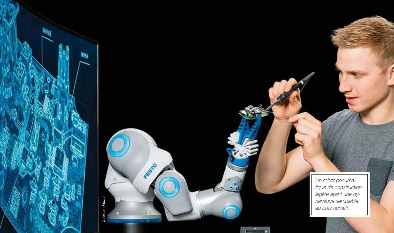
Un robot pneumatique de construction légère ayant une dynamique semblable au bras humain
