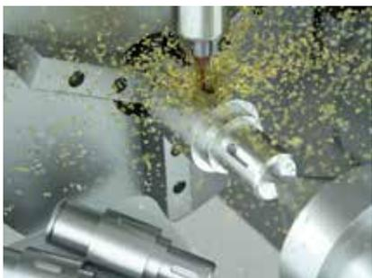
**SIAMS / C19 / 1.2** – La CrazyMill Cool, une fraise « à percer » est nouvelle et unique dans son genre. Elle peut entrer verticalement dans la pièce jusqu'à 1 x d [percer] pour ensuite fraiser des rainures ou des poches dans le
