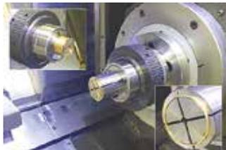
Spannzange, überschüssige Spannkraft wird in den Futterkörper abgeleitet. Diese Eigenschaft ermöglicht es, fragile Werkstücke mit sehr dünnwandigen Wandstärken automatisiert auf zwei Seiten komplett herzustellen.
