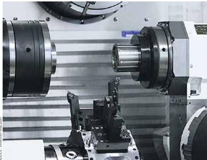
Le centre d'usinage le 508MT2 Linear 6-8 axes de Willemin-Macodel.
