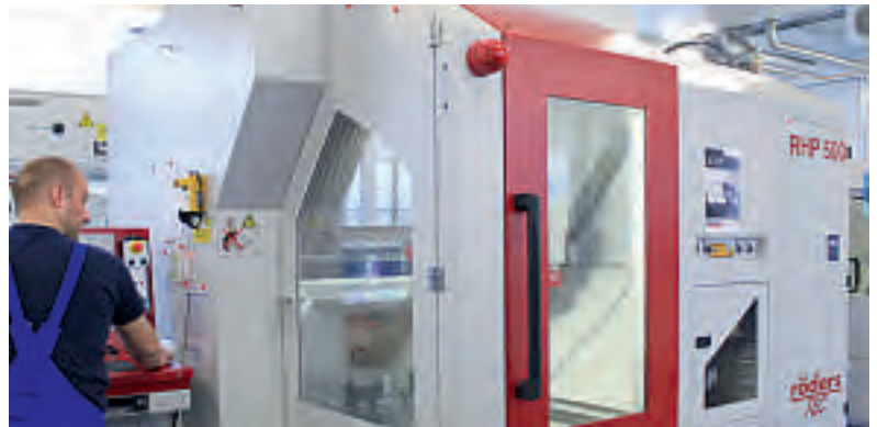
Das bei Feintool eingesetzte Rödgers-Bearbeitungszentrum RHP 500 bewährt sich beim HSC-Fräsen ebenso wie beim Koordinatenschleifen selbst ultraharter Werkstoffe mit bis zu 66 HRC. (Bilder: Klaus Vollrath)
