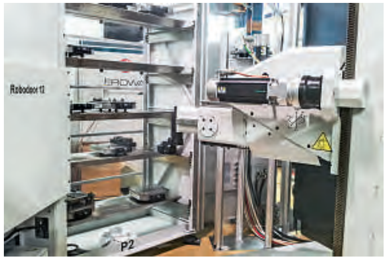
Der extralange Roboterarm bewegt Werkstücke bis 200 kg genauso souverän wie die leichten Elektrodenhalter der Grösse 50 mm. (Bilder: Erowa)
