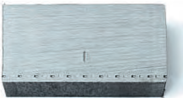
Das Vorprägen von Werkstücken ermöglicht trotz geringem Spanndruck hohe Haltekräfte. (Bild: Intool)
