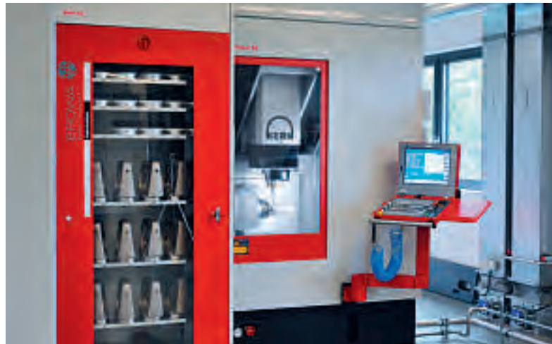
Präzision für Implantate: Mit elf Fräsmaschinen des Typs Kern Micro fertigt Etkon mit höchster Genauigkeit Teile für Zahnersatz.
