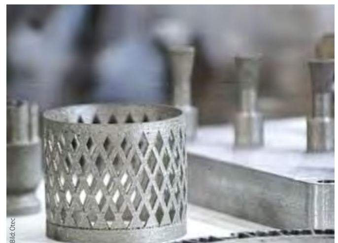
Perfektes Finish: Bei additiv gefertigten Bauteilen sorgen Gleitschleifen und elektrochemische Verfahren für glatte und saubere Oberflächen.
