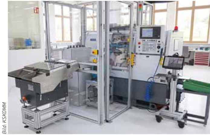
Miyano BNA-42CY5 zum Rändeln von Klingenrohlingen. Im Vordergrund links die Roboterzelle mit vorgeschaltetem Vereinzelungsförderer, rechts der Ablagekorb nach der Bearbeitung.
