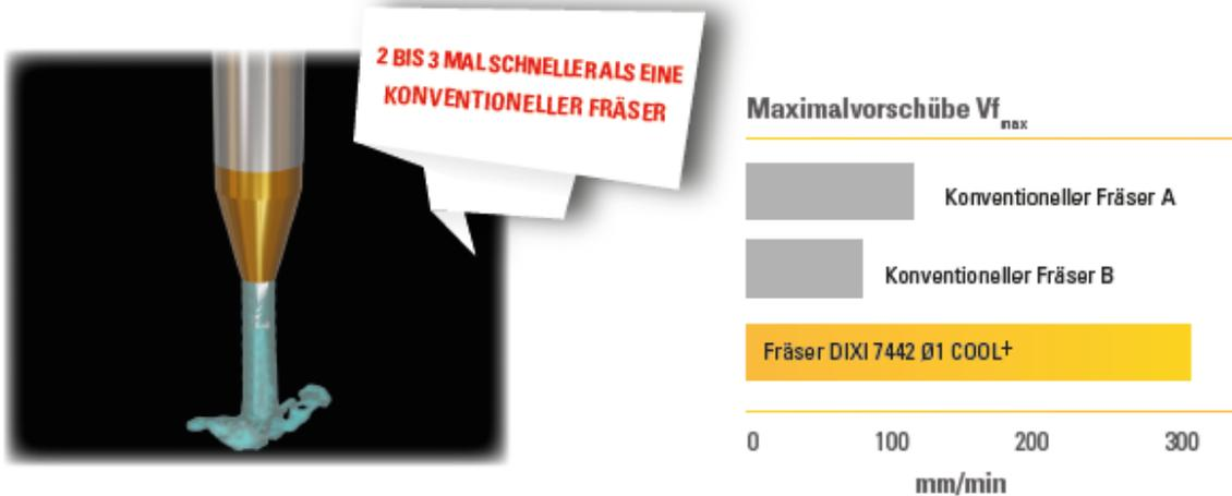
Tests in Edelstahl durchgeführt 1.4441
