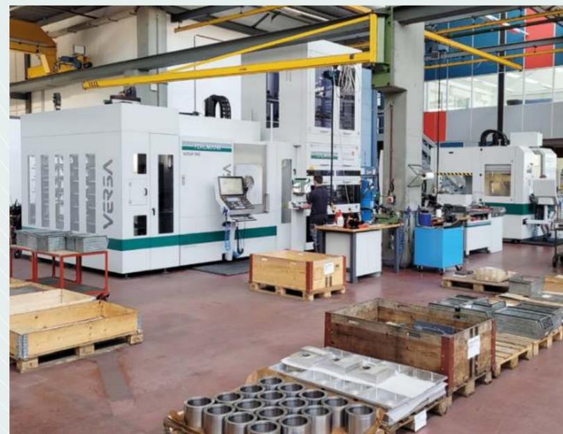
Seit 2022 ist in der FEHLMANN-Produktion eine neue, kompakte und energieeffiziente VERSA-Fertigungsanlage im Einsatz: die VERSA 945 mit Regalmagazin RM 256 und Automationslösung Erowa Leonardo Multilevel. Damit werden verschiedene Bauteile in höchster Präzision, zuverlässig und äusserst wirtschaftlich gefertigt. Der Fertigungsprozess läuft automatisiert, mannarm und mannlos im Zwei- bis Dreischicht-Betrieb.
