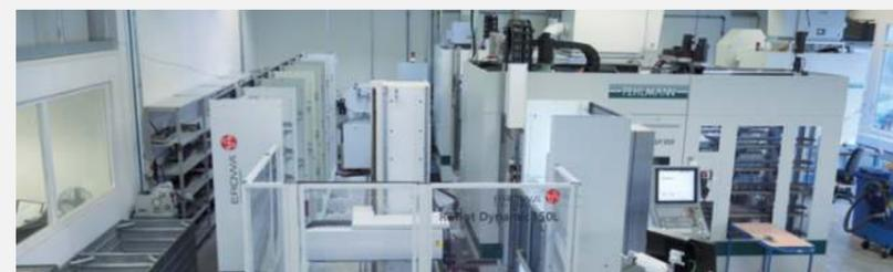
Zwei VERSA-5-Achs-Bearbeitungszentren mit modularem Robotersystem Erowa Robot Dynamic 150L
