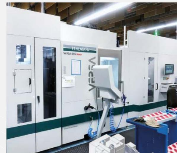
Zwei VERSA-5-Achs-Bearbeitungszentren mit je einem Regalmagazin an robotergestütztem Teile-Handlingssystem
