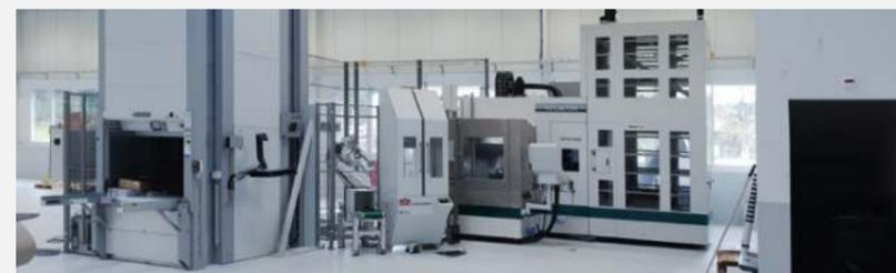
Fertigungsinsel VERSA-5-Achs-Bearbeitungszentrum mit Regalmagazin, Knickarmroboter für Teilehandling und Hochregal-Roh- und Fertigteillager
