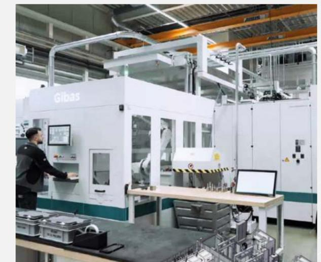
Werkstück-Roboter an fünf VERSA-5-Achs-Bearbeitungszentren mit Regalmagazin
