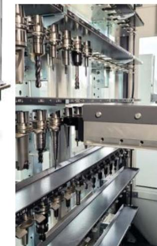
Je nach Werkzeugaufnahme und Werkzeugdimensionen bieten diese skalierbar von 112 bis zu 432 Werkzeugen (HSK-A63) bzw. von 160 bis zu 600 Werkzeugen (HSK-E50) Platz. Angeordnet werden die Erweiterungsmagazine platzsparend auf der linken Seite der Maschine. Die Bestückung erfolgt einfach und schnell von vorne über eine externe Beladeinheit.
