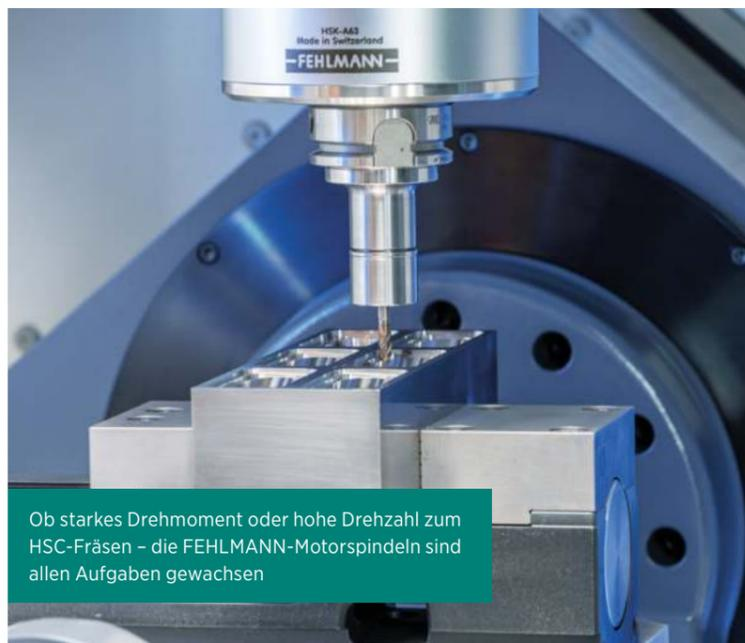
Ob starkes Drehmoment oder hohe Drehzahl zum HSC-Fräsen – die FEHLMANN-Motorspindeln sind allen Aufgaben gewachsen
