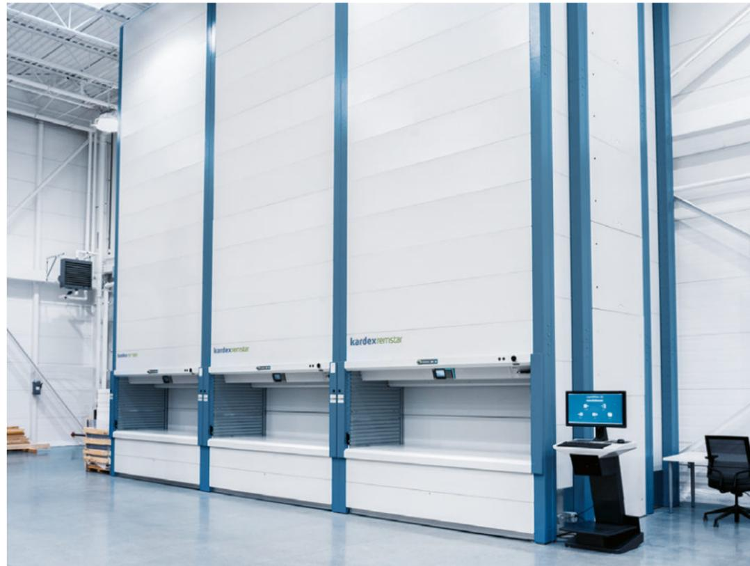
Un Vertical Lift Module (VLM) est un système clos dans lequel des plateaux sont disposés verticalement à l'avant et à l'arrière de la machine, avec une navette ou élévateur placé au centre. Le dispositif de navette se déplace vers le haut et le bas entre les plateaux stockés, en les localisant et les distribuant automatiquement dans des ouvertures d'accès aux plateaux.
