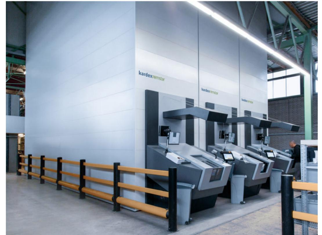
Un Vertical Buffer Module (VBM) contient un système de rayonnage à segments multiples avec une allée centrale où se déplace un mât mobile avec une pince télescopique. Celui-ci délivre automatiquement dans un sas de prélèvement les bacs 600 × 400 mm ou les plateaux 640 × 440 mm contenant les articles demandés par simple pression sur un bouton ou par pilotage informatique.
