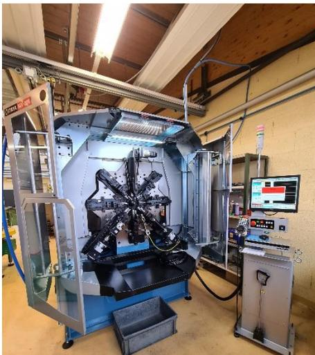
Die neueste Entwicklung in der ITAYA MX-Serie verfügt über insgesamt 15 Achsen, 8 Servo-oszillierende Schlitten und 2 Servo-Drehungen.
