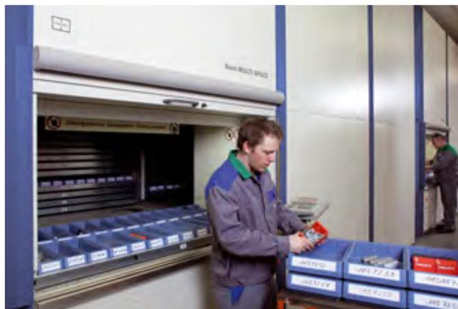
Les points de prélèvement sont sécurisés par la porte rapide Hänel, ce qui permet de travailler en même temps sur les deux
