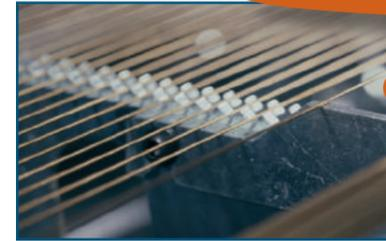
Le système de **sélection** des barres est très précis, il permet de sélectionner les **barres de 0,8 mm en évitant tout chevauchement**.
