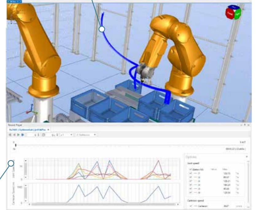
Enregistrement de la simulation via l'émulateur dans un environnement 3D
