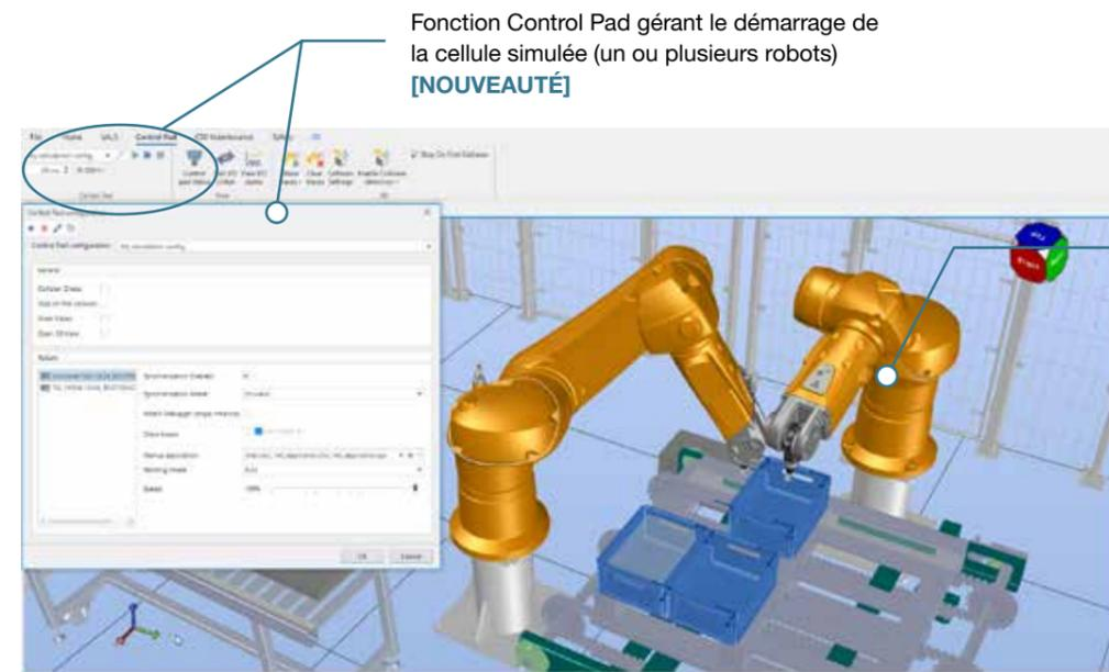
Fonction Control Pad gérant le démarrage de la cellule simulée (un ou plusieurs robots) [NOUVEAUTÉ]
