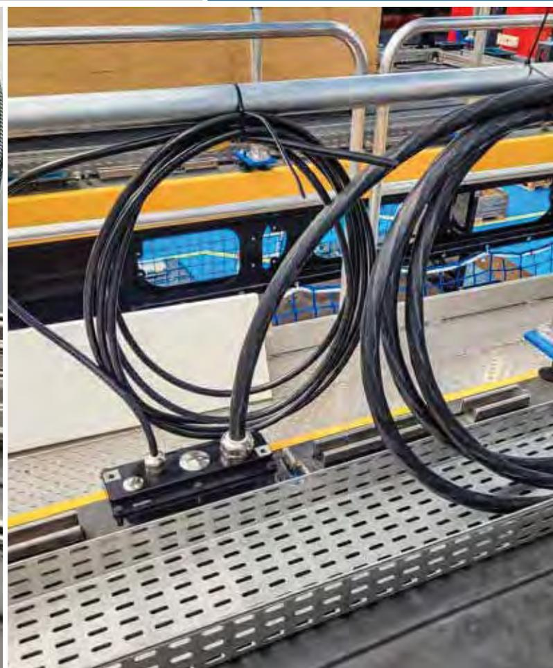
La première plaque adaptatrice au monde pour l'introduction de plusieurs câbles offre une solution sûre pour les véhicules ferroviaires électriques et les bus et camions alimentés par caténaire. Par cette innovation, AGRO a résolu des problèmes à la fois d'exploitation et de construction des véhicules.
