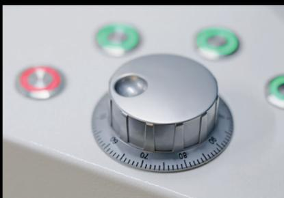
Pilotage facilité par une molette pour l'activation des axes numérisés et par quatre boutons de contrôle pour l'activation de fonctions et la correction du diamètre par pas de +/- 0.001 et 0.0001
