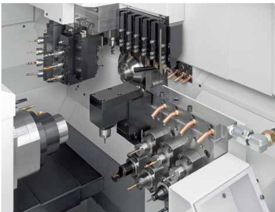
Je nach Modell kann der Kunde mit den Achsen B oder Y2 für die Rückseitenbearbeitung aufstocken und die Anzahl der Werkzeuge deutlich erhöhen.
