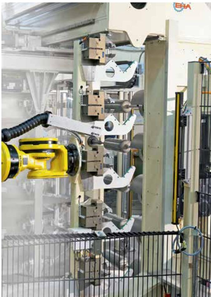
Mithilfe des Universalgreifer PGN-plus werden die Liner von einem Industrieroboter in die Vorderendfutter ROTA TP geladen und dort präzise gespannt.
