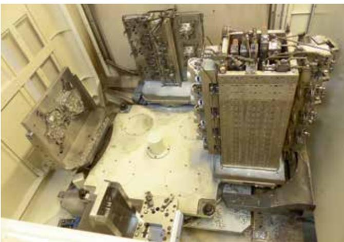
Zwei der 4-Achs-Bearbeitungszentren H 4000 sind mit Rundspeichern und einem 6-fach-Paletten-Rundspeicher ausgerüstet.
