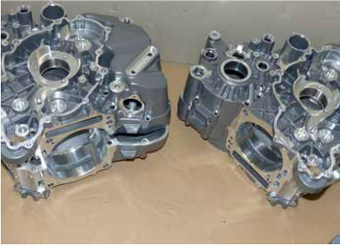
Wichtig bei KTM ist, dass die erforderliche Präzision von zwei Hundertstel Millimetern erreicht wird und diese mit der entsprechenden Reproduzierbarkeit über tausende von Bauteilen sichergestellt ist.
