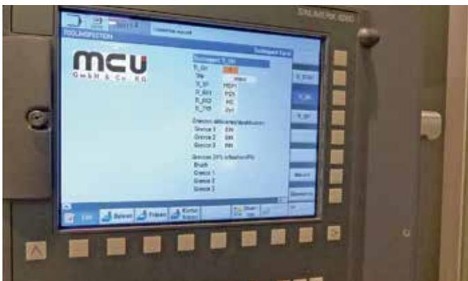
*Für die Steuerung Siemens 828D erfolgte durch MCU zusätzlich die Einbindung über Profi-Net.*
