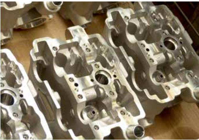
Motorgehäuse werden nach Bedarf gefertigt, saisonabhängig. Insgesamt sind es 150 unterschiedliche Varianten, die Losgrößen bewegen sich zwischen 100 bis 2000 Stück.
