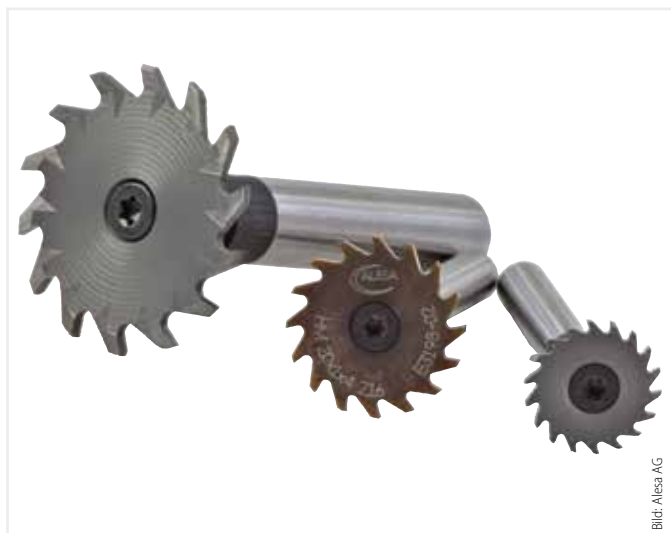
Sägen für tiefe Nuten bei grossen Nutbreiten: Die Aufnahme mit sieben Nocken überträgt bei kleinen Schaftdurchmessern grosse Drehmomente.
