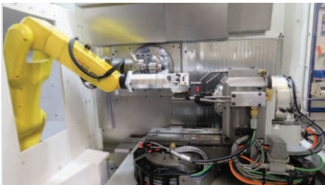
Beladen eines Rohlings auf die Spindel des Grindsmart 830 XW und Entladen eines fertigen Werkzeugs durch den Fanuc-Roboter. Der Fanuc-Motor mit Direktantrieb gewährleistet eine kontinuierliche Positionierung des Werkzeughalters der C-Achse mit einer Auflösung von 0,00001°. (Bilder: Rollomatic)
