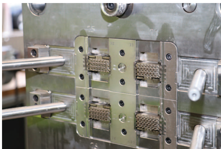
Die Steckverbinder entstehen aus komplexen Spritzguss-Werkzeugen mit bis zu 128 Kavitäten. Die Anforderungen der Formeinsätze, Schieber etc. solcher Stecker-Werkzeuge erfordern hohe Präzision hinsichtlich der Masse, Ebenheiten und Winkligkeiten.
