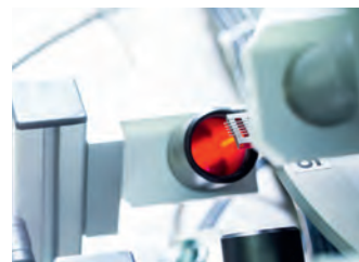
Contrôle optimal : deux caméras contrôlent la rectitude d'un lot de quatre micro-axes
