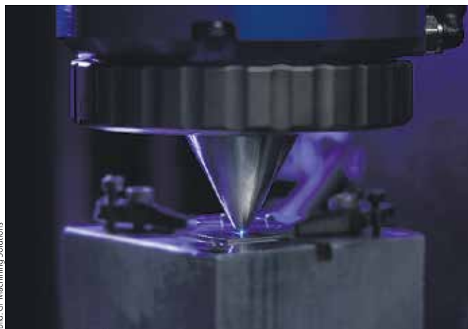
Die fünfschichtige ultraschnelle Microlution ML-5 Laser-Mikrobearbeitungs-Plattform bohrt, fräst und schneidet ohne Wärmeeinflusszone und liefert innerhalb von Sekunden Präzisionsteile.
