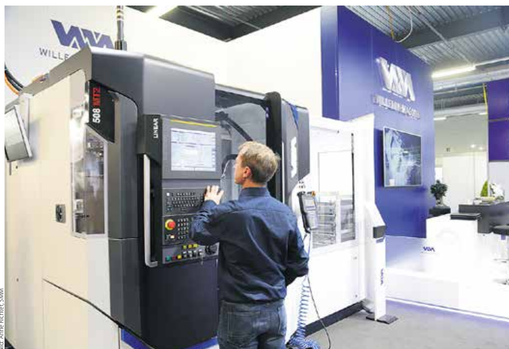
Das Multiprozess-Bearbeitungszentrum mit 6 bis 8 Achsen 508MT2 Linear von Willemin-Macodel ist für die Komplettbearbeitung komplexer Bauteile in nur einem Bearbeitungszyklus.
