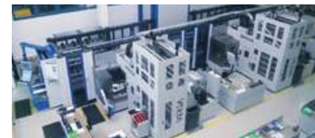
Lineare Automationslösung aus zwei VERSA 825 mit Regalmagazinen für je bis 346 Werkzeuge
