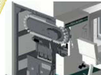
Grundausführung Kettenmagazin mit 50 Werkzeugen
