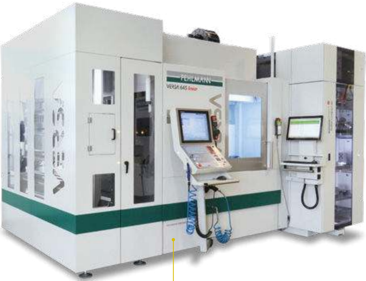
VERSA 645 linear avec système de palettisation ERC 80 (à droite) et magasin à rack jusqu'à 250 outils (à gauche). Différentes tailles de magasins sont disponibles.
