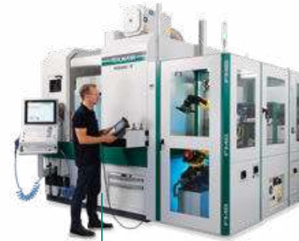
Système robotique modulaire à 6 axes pour la manipulation des pièces brutes
