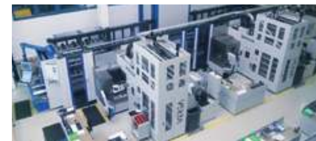
Solution d'automatisation linéaire avec deux VERSA 825 avec magasins à rack de chacun 346 outils
