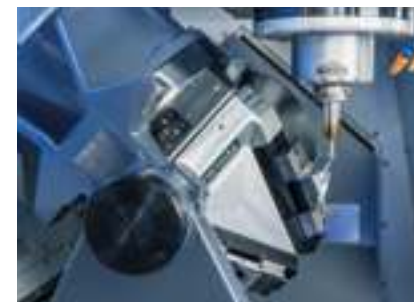
Option magasin à rack : le nombre d'outils peut être échelonné en fonction du porteoutil / des dimensions des outils. Exemple RM256 : HSK-A63 avec 224, 256 ou 288 outils ou HSK-E50 avec 320, 360 ou 400 outils
