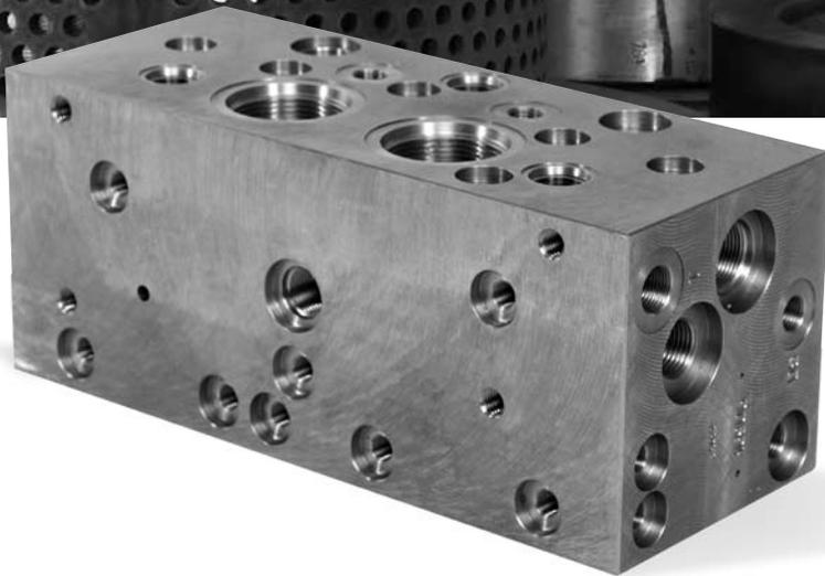
TEM steht für die thermische Entgratmethode und ist Teil unseres Angebotes. In einer geschlossenen Kammer werden die Teile von einem Brenngasgemisch um- und durchströmt, so dass bei der Zündung die Grate an schwer zugänglichen Stellen sowie an der Oberfläche verbrennen.
