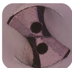
Trous \varnothing 0.15 Pour un foret classique
