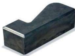
Pièce oxycoupée avec chanfrein sur le contour extérieur
