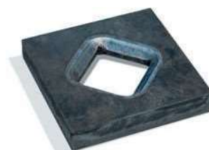
Pièce oxycoupée avec chanfrein sur le contour intérieur
