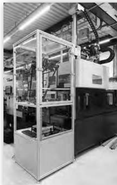
Messzelle mit Werkzeugkorrektur Rückspeisung an DNS PUMA TW2600GL
