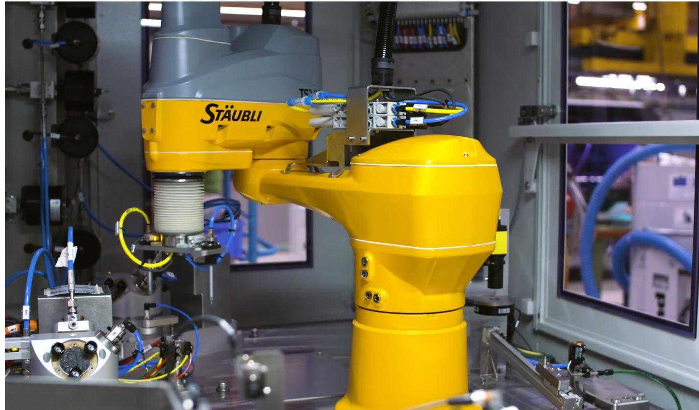
« Nous recherchions un robot robuste capable de fonctionner en continu, tout en garantissant une précision et une répétabilité de 2 à 3 centièmes de millimètre, et suffisamment rapide pour respecter le temps de cycle demandé par le client. En raison du faible volume de la cellule, le robot TS2-60, très compact, est idéal pour notre application. »
