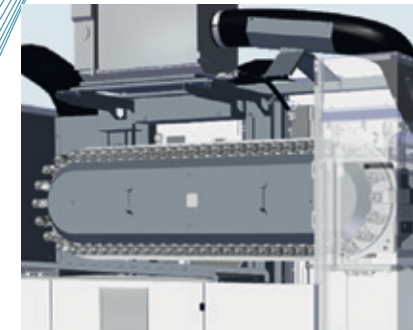
PICOMAX 550 PRO: Werkzeugwechselsystem mit Kettenmagazin für 60 Werkzeuge.
