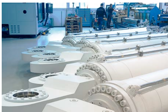
Monster-Zylinder zum Öffnen des Daches einer Eventhalle.
