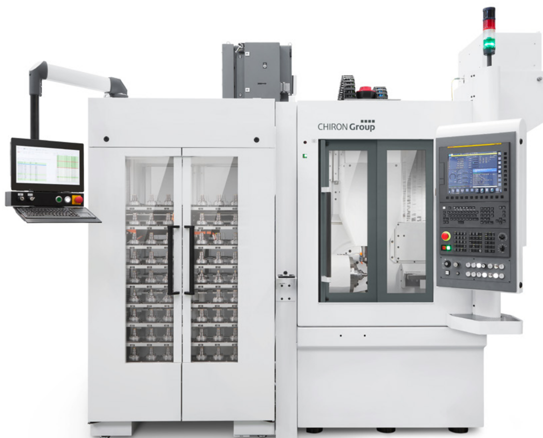
Solution d'automatisation individuelle VariocellSystem : FZ 08 S five axis avec stockage de palettes
