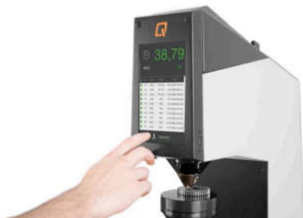
QATM a développé un écran couleur de 7" avec un cadre robuste en tôle d'acier pour le Qness 150 CS. L'écran utilise la technologie tactile capacitive et a été optimisé pour garantir une précision opérationnelle et des temps de réaction rapides. Le nouveau logiciel Qpix TE garantit une utilisation simple avec des boutons plus grands et une interface logicielle plus moderne et intuitive.
