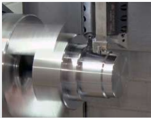
Nutenbearbeitung mittels Mehrfach-Werkzeughalter
