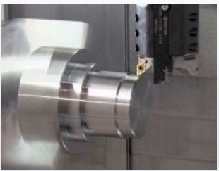
Außendurchmesserbearbeitung (fein) mittels Mehrfach-Werkzeughalter
