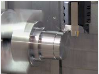
Außendurchmesserbearbeitung (grob) mittels Mehrfach-Werkzeughalter
