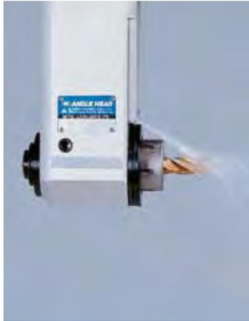
Les têtes à renvoi d'angle augmentent la précision et la productivité puisqu'elles permettent un usinage vertical, horizontal ou oblique sans avoir à repositionner la pièce. Le travail dans une seule position d'outil, avec réglage facile de l'angle de la partie travaillante sur 360 degrés, accélère la production et évite les erreurs causées par le changement d'outil.
