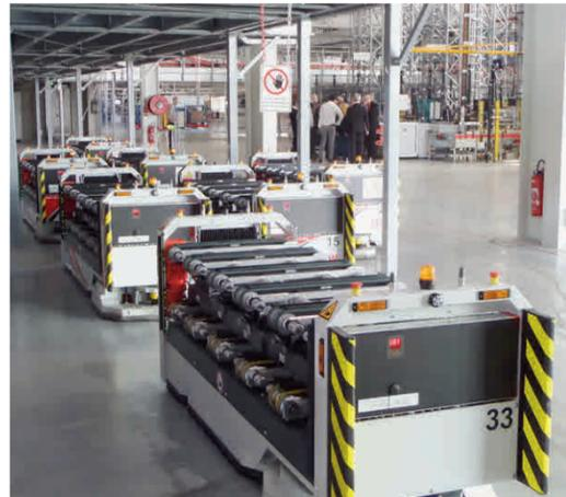
**AUTOMATISATION** Les AVG – traduit de l'anglais par Véhicules à guidage automatique – transportent la production en se déplaçant seuls par induction, grâce à des câbles placés dans le sol.
