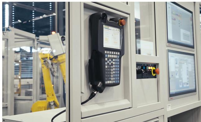
Tableau de commande de la cellule robotisée.
