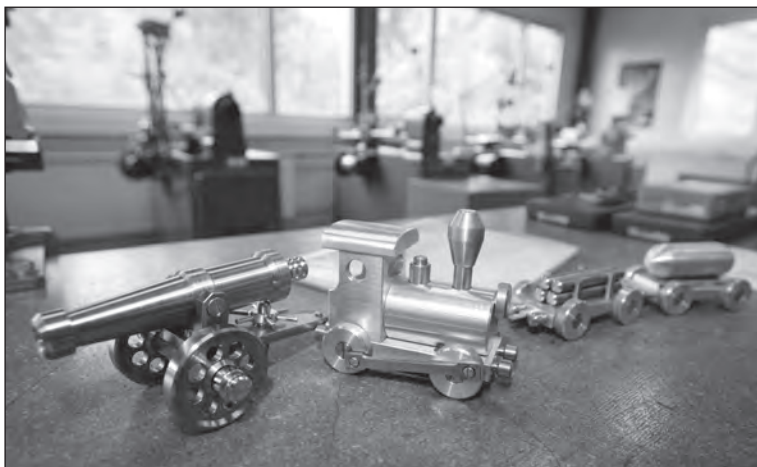
Grâce au décolletage, fraisage et perçage, le travail entièrement réalisé par les apprentis du CAAJ: un petit train en acier et laiton.
