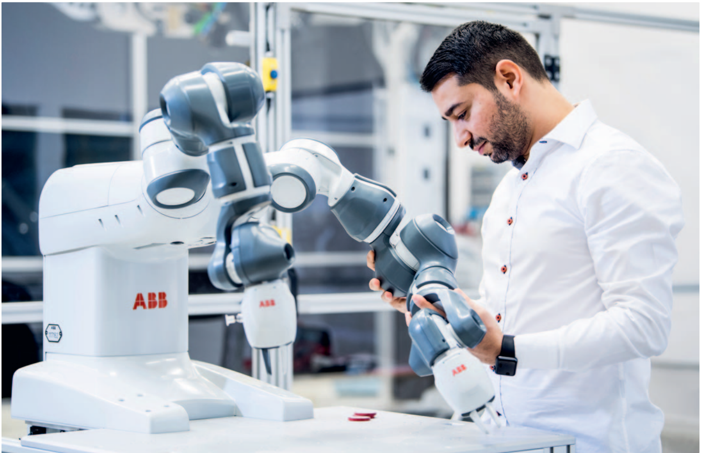
Les robots collaboratifs YuMi ont été conçus pour une parfaite intégration à l'environnement de travail. Destinés à l'homme, ils sont légers et facilement adaptables.
