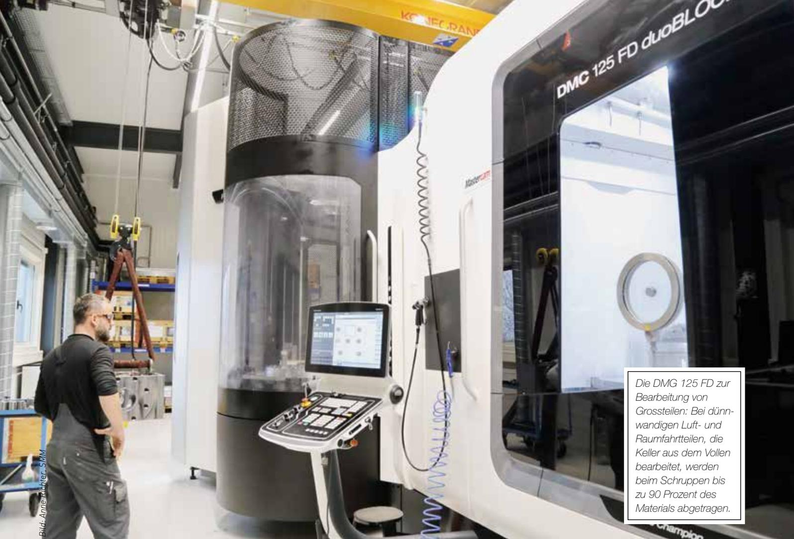
Die DMG 125 FD zur Bearbeitung von Grossteilen: Bei dünnwandigen Luft- und Raumfahrtteilen, die Keller aus dem Vollen bearbeitet, werden beim Schrappen bis zu 90 Prozent des Materials abgetragen.
