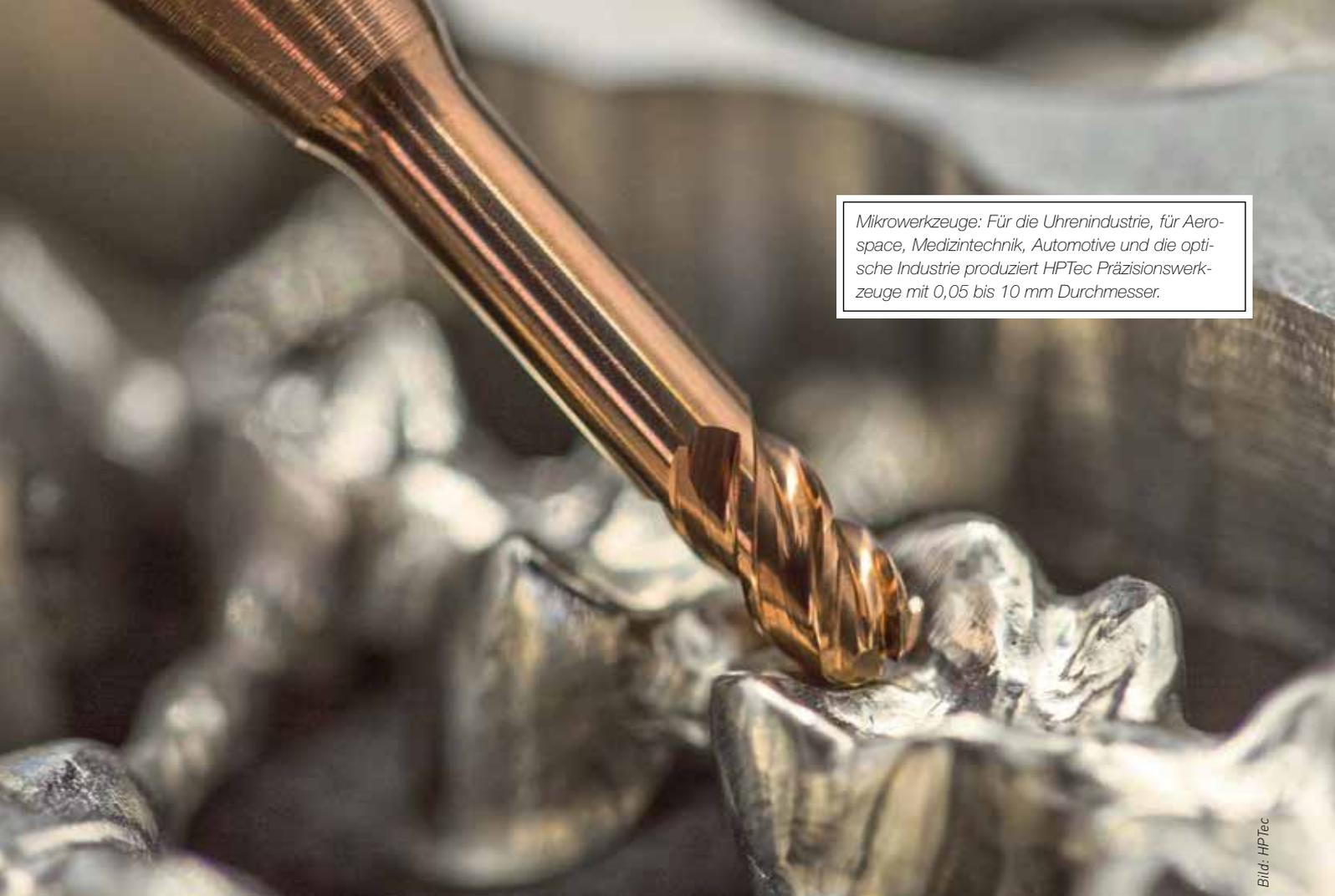
Mikrowerkzeuge: Für die Uhrenindustrie, für Aerospace, Medizintechnik, Automotive und die optische Industrie produziert HPTec Präzisionswerkzeuge mit 0,05 bis 10 mm Durchmesser.
