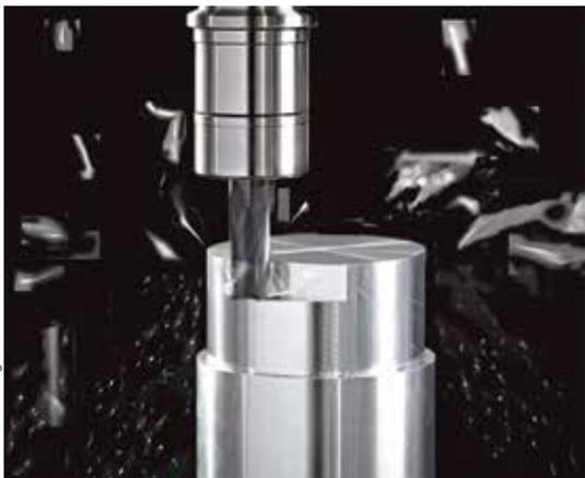
*Maschinelle Bearbeitung: Variable Spindeloptionen ermöglichen höchste Geschwindigkeit und höchstes Drehmoment.*
