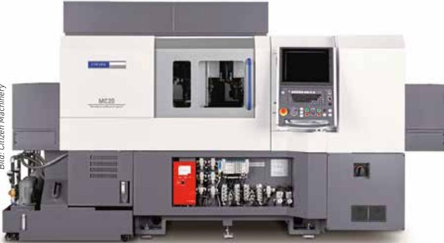
Ausgestattet mit drei beziehungsweise vier Spindelmodulen, die simultan arbeiten und sich das Werkstück vollautomatisch weiterreichen, haben lästige Stillstandzeiten, aufwändige Ladevorgänge bzw. Umrüstvorgänge mit der Cincom MC20 ein Ende.
