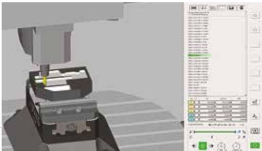
Simulation für prozesssicheres Bearbeiten: Die Software hyperMILL Virtual Machining verbindet virtuelle Modelle mit realen Maschinen.
