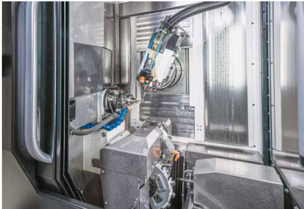
C'est une fois à l'intérieur que la différence saute aux yeux avec l'intégration d'une seconde unité 3 axes avec la seconde motobroche haute vitesse et son magasin d'outils dédié.
