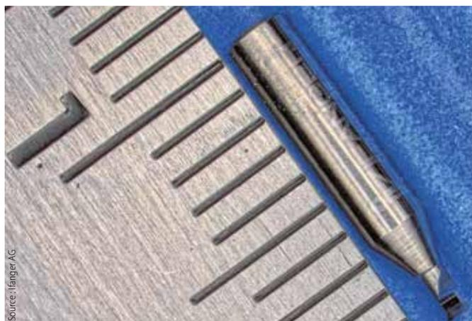
MicroTurn MTKN 20401-L-K20 pour diamètre mini Ø 0.40 mm.
