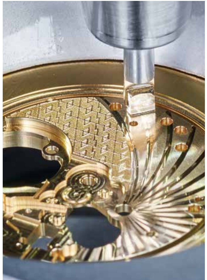
Platine de démonstration réalisée sur 701S, de la barquette à la pièce terminée : usinage recto-verso, décoration et détourage sont réalisés dans le même cycle.
