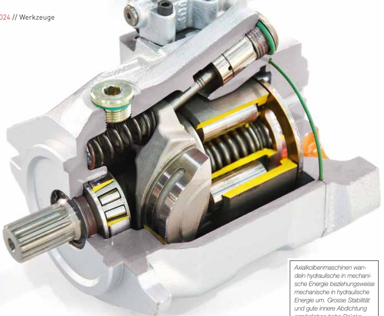
*Axialkolbenmaschinen wandeln hydraulische in mechanische Energie beziehungsweise mechanische in hydraulische Energie um. Grosse Stabilität und gute innere Abdichtung ermöglichen hohe Drücke.*
