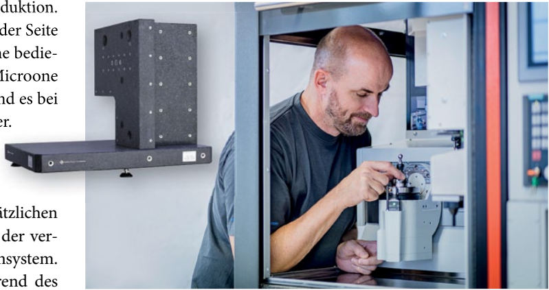
Das Mikrobearbeitungszentrum bietet Zugang von zwei Seiten.
