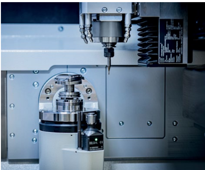
Klein und Präzise: Das 5-achsige Mikrobearbeitungszentrum «Microone» lässt sich auf unterschiedliche Fertigungsabläufe zuschneiden. (Bilder: Zorn)
